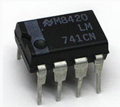
Amplificador operacional modelo LM741CN de National Semiconductor con encapsulado plástico DIP
